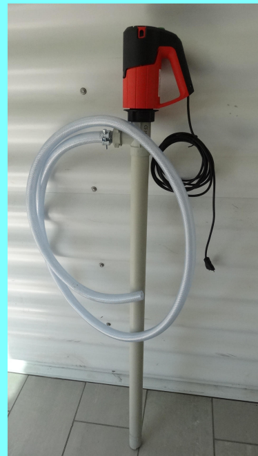
Pompe de transfert
