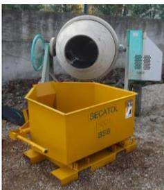
Betonkübel BSB mit 1 M Schlauchauslauf befördert mit einem Telehandler.
